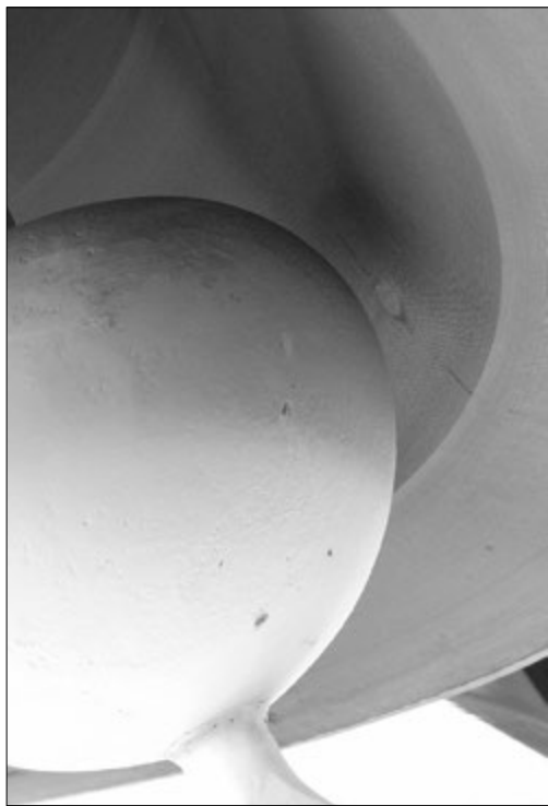
Постепенно язык колокола оставляет след в месте постоянного удара, поэтому необходимо менять положение колокола, чтобы язык ударял в другую точку
