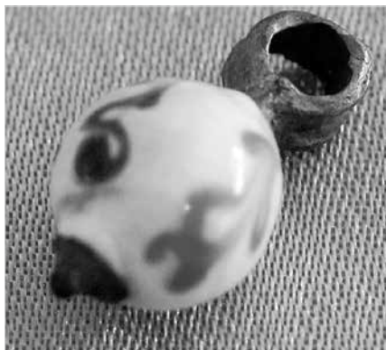
Ил. 4. Образец белой пуговицы с некачественным эмалевым фоном; внизу – а) белая пуговица общим белым эмалевым покрытием – фоном, включая углубления; справа – б) пуговица с травчатой росписью розовой краской нанесенной не по углублениям
